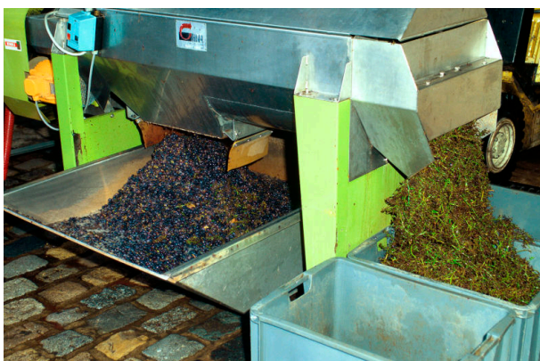
Figura 11 - O desengace da uva (é visível a saída à esquerda da uva desengaçada e à direita o engaço) [Cássia, 2016]
