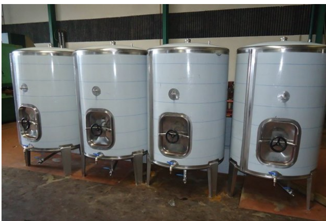
Figura 18 - Maturação do vinho em depósitos de inox
