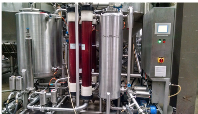
Figura 19 - Filtragem do vinho através do filtro tangencial (a bebida passa por tubos verticais nos quais é aplicado o método de filtração crossflow)
