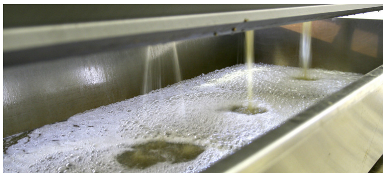
Figura 15 - Prensagem em prensa horizontal (as massas são diretamente separadas do vinho)
